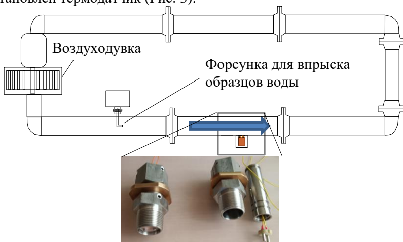
Рисунок 3 – Схема экспериментального стенда и общий вид резистивного датчика
